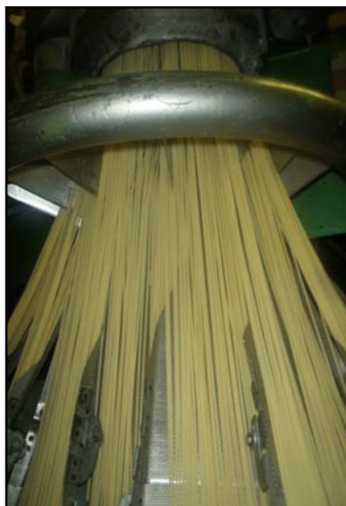
Foto 2. Estrusionadora: salida de espagueti.
